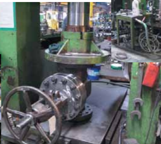
▲第三者機関(ロイドレジスター)による立合検査風景
